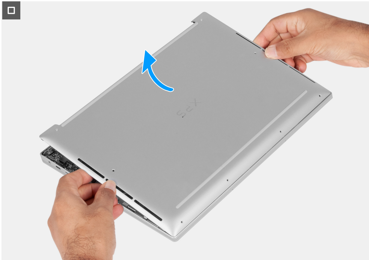
Ilustración 16. Extracción de la cubierta de la base
