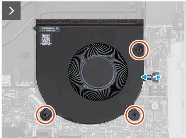
Ilustración 25. Extracción del ventilador de la CPU
