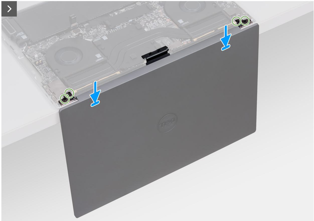
Ilustración 42. Instalación del ensamblaje de la pantalla
