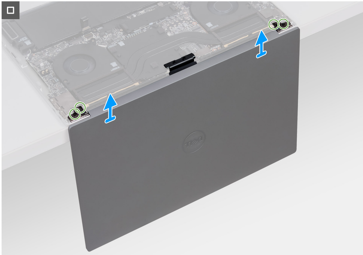
Ilustración 40. Extracción del ensamblaje de la pantalla
