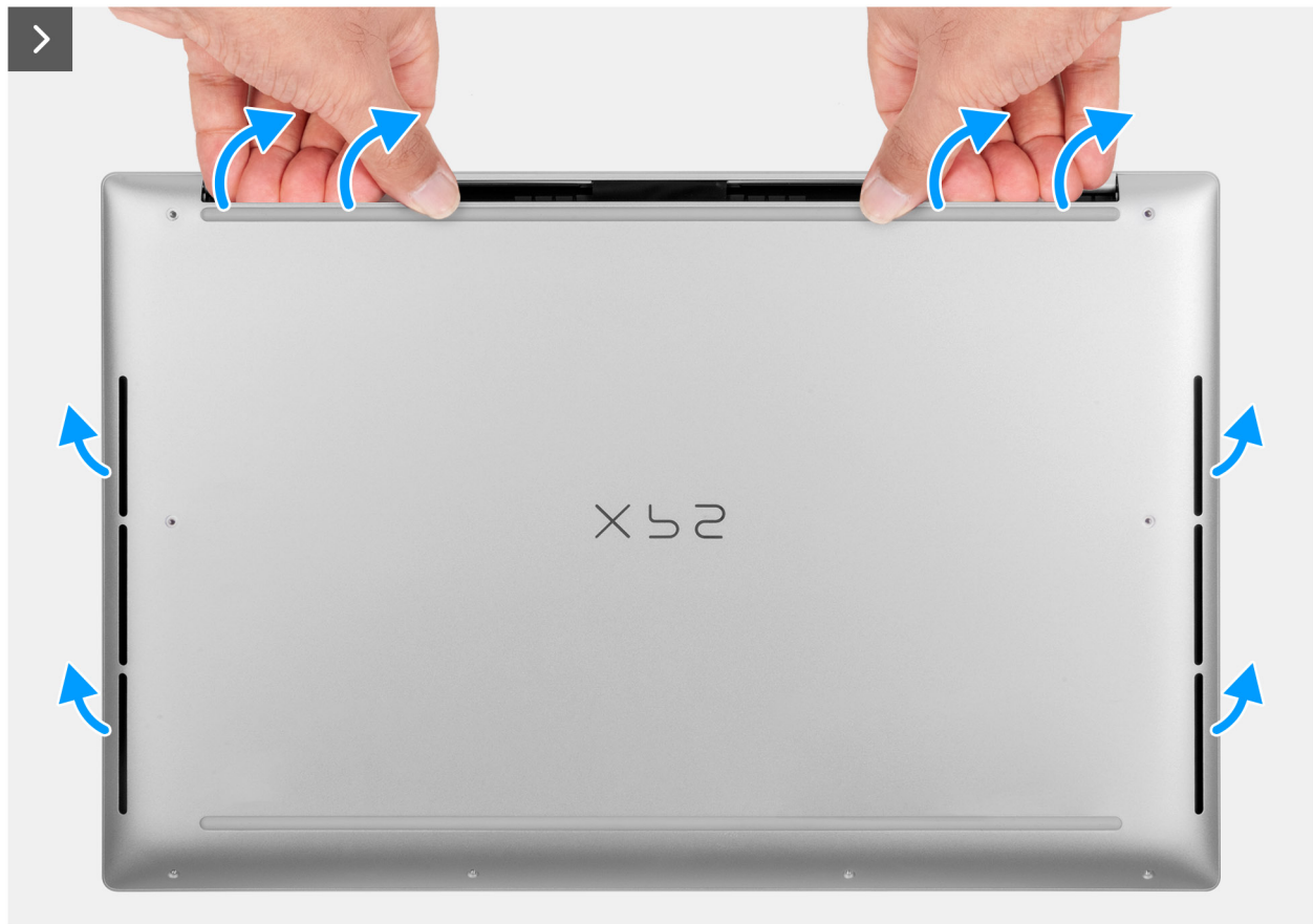
Ilustración 15. Extracción de la cubierta de la base
