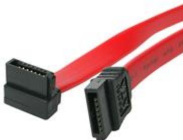
El cable SATA en ángulo derecho (90 grados) SATA18RA1 incluye una receptáculo SATA estándar (recta), así como una receptáculo SATA en ángulo derecho, lo cual proporciona una conexión simple de 45 cm con cualquier unidad Serial ATA, con soporte total de ancho de banda SATA 3.0 de hasta 6 Gpbs cuando se utiliza con unidades compatibles con SATA 3.0.
