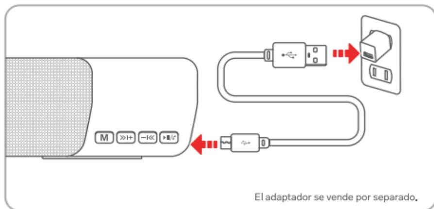
*El LED encendido en rojo indica que la batería está cargando; se apaga cuando la batería está completamente cargada.*
