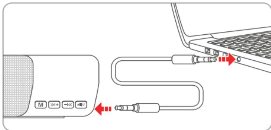
Al hacer la conexión la bocina cambiará automáticamente a la entrada auxiliar, de lo contrario presiona **M** (modo hasta cambiar a este modo).
