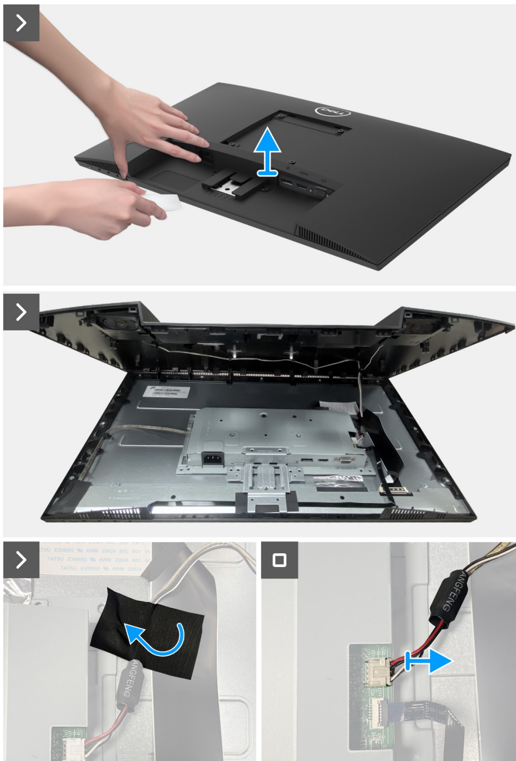
Figura 14. Quitar el cubierta posterior
