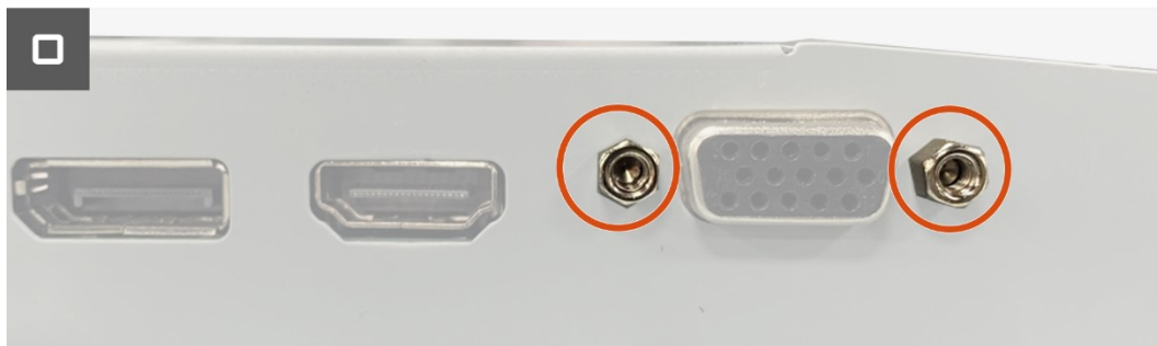
Figura 32. Instalar la placa de la interfaz
