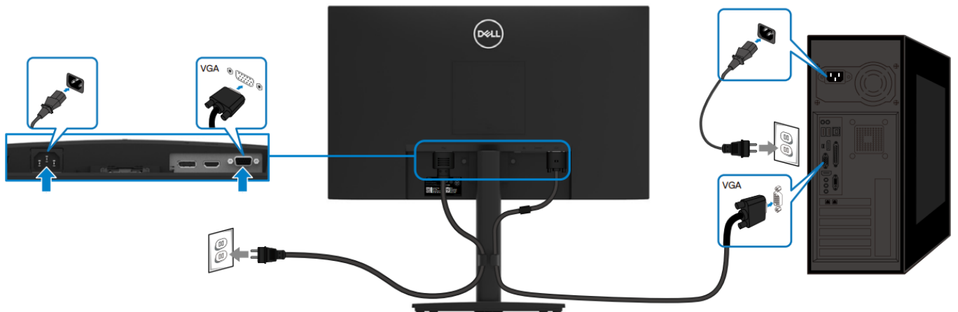
Figura 6. Conectar el cable VGA
