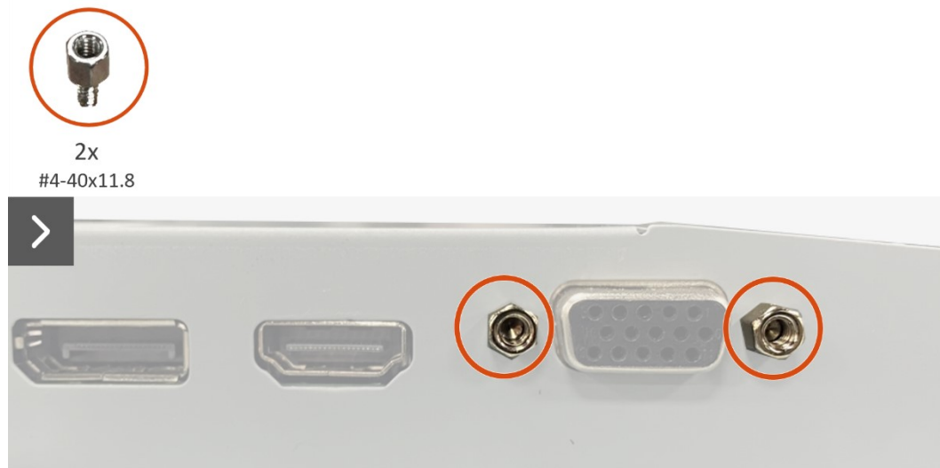
Figura 28. Retire la placa de la interfaz
