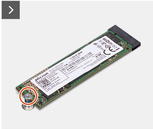
Ilustración 19. Extracción de la unidad de estado sólido M.2 2280
