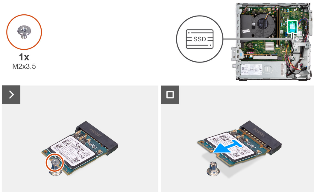
Ilustración 17. Extracción de la unidad de estado sólido M.2 2230
